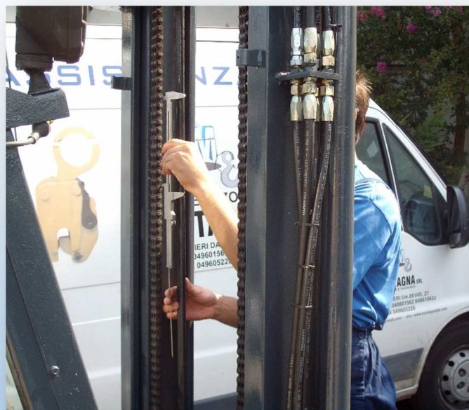
Controllo catene montante dei carrelli elevatori
