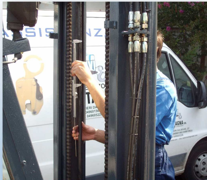
Controllo catene montante dei carrelli elevatori
